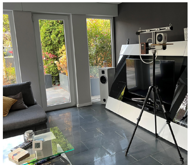
Abb. 1: Stationäres GSP-System zur Probenahme von einatembarem Staub, Apollosammler und Thermohygrometer zur Sammlung von Staub im häuslichen Umfeld.
