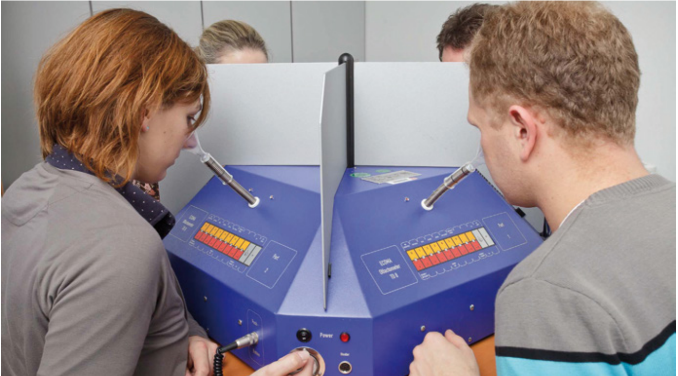
Abb.2: Mit Hilfe des Olfaktometers kann der Geruchssinn geprüft werden.
