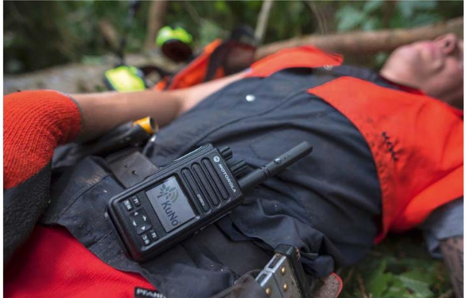
Abb. 4: Automatische Auslösung eines Lagealarms durch das Kommunikations- und Notrufgerät
