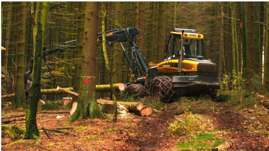
Abb. 1: Vollmechanisierte Holzernte mit Harvester
