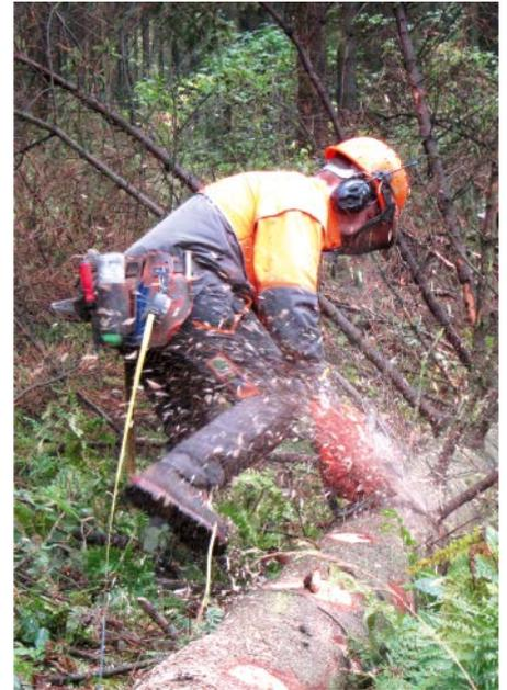
Abb. 2: Aufarbeiten mit der Kettensäge
