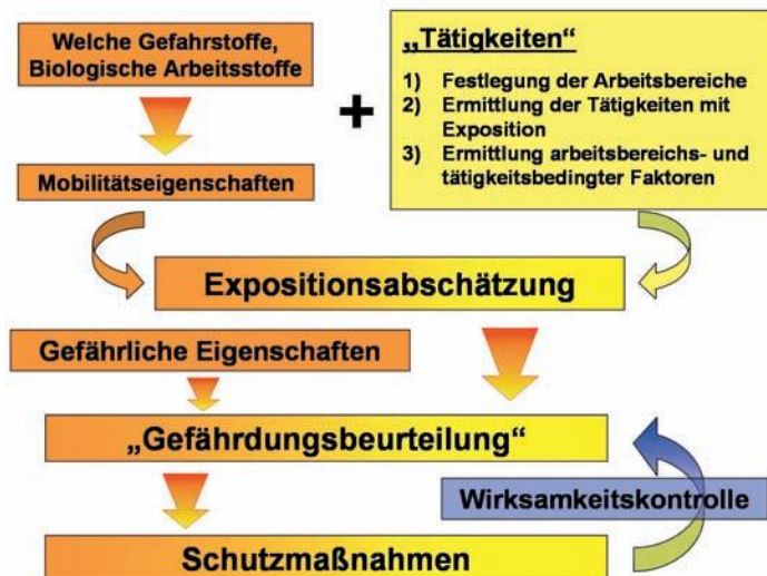
Abb. 3: Inhalte des Arbeits- und Sicherheitsplans nach BGR 128 – Gefährdungsbeurteilung und Festlegung der Schutzmaßnahmen seitens des Bauherrn zur Vorbereitung einer VOB-gerechten Ausschreibung
