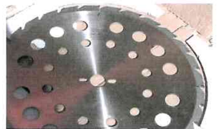
Abb. 7: Sägeblatt zum Schneiden von Polystyrol und Holzwerkstoffen (Foto: Opara)
