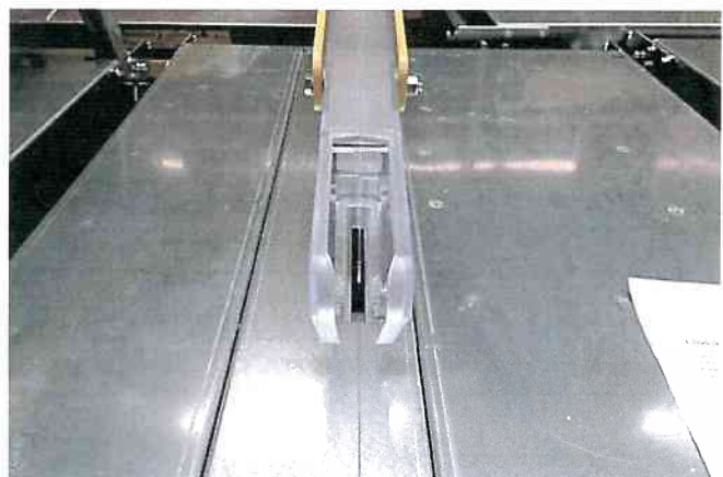
Abb. 5: Aufweitung des Sägeschlitzes an der Schutzhaube und Schnittverlängerung im Maschinentisch (Foto: Opara)
